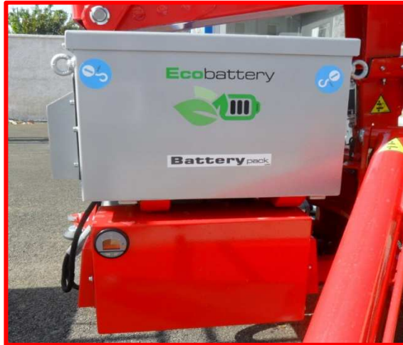
Figure 17 : bloc batteries au lithium.
