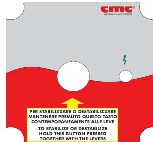
Afbeelding 39: kastje “dodemannsfunctie” voor stabilisatie/destabilisatie.
