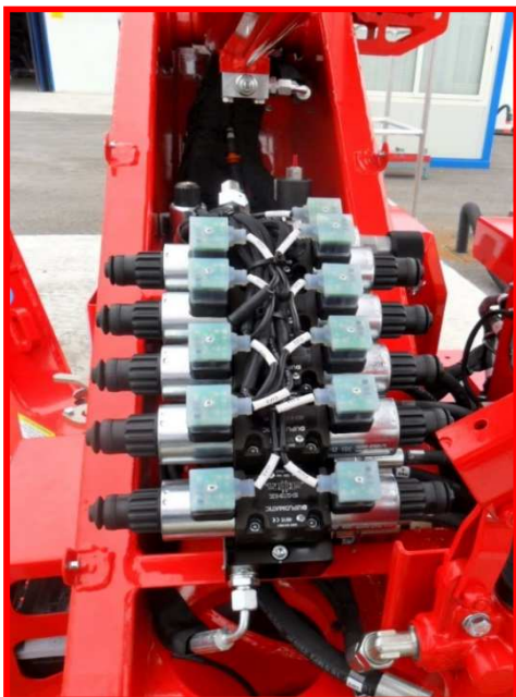
Figure 15 : banc vanne poste d'urgence.
