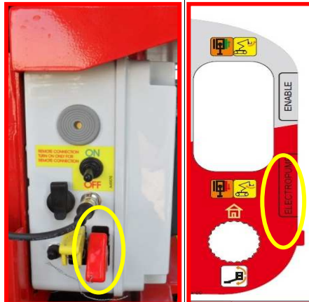
Afbeelding 29: knoppen elektrische pomp.
