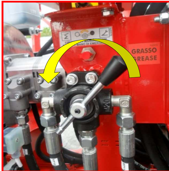
Afbeelding 21: hendel van de handpomp op stand herstel platform.
