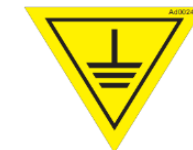
Figure 75 : mise à la terre.
