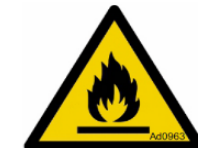
Figure 55 : danger de substances inflammables.
