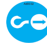
Figure 62 : points d'attache pour soulever PEMP.
