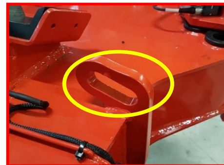
Afbeelding 16: bevestigingspunten op het onderstel voor het ophangen van de hoogwerker.
