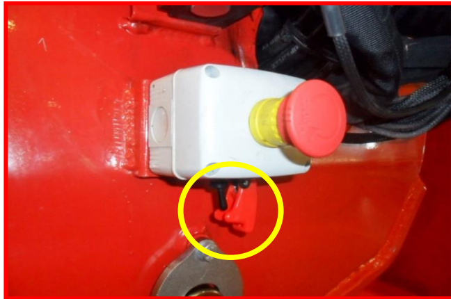
Figure 45 : bouton de by-pass de blocage de translation.
