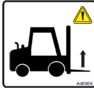
Figure 97 : indication des points d'enfourchement.
