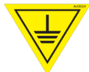
Figure 107 : mise à la terre.
