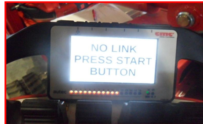
Figure 15 : avertissement de la radiocommande non connectée.
