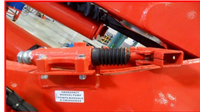
Figure 60 : point d'intégration de la pompe manuelle.
