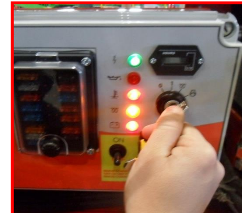
Figure 5 : phase de chauffage des bougies du moteur.
