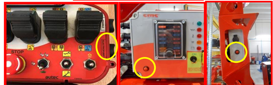
Figure 62 : activation de l'électropompe (*en option).
