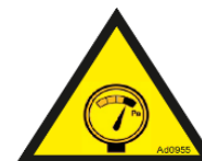
Figure 110 : danger de haute pression.
