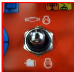
Afbeelding 7: hendel start/stop verbrandingsmotor/elektrische Motor op de afstandsbediening.
