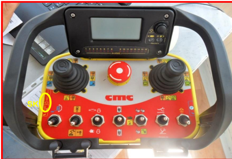
Figure 13 : poste AUTEC télécommande filaire/radiocommande.
