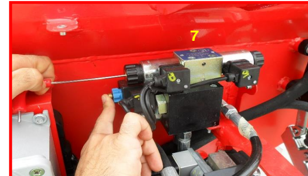
Figure 34 : vanne de mise à niveau.
