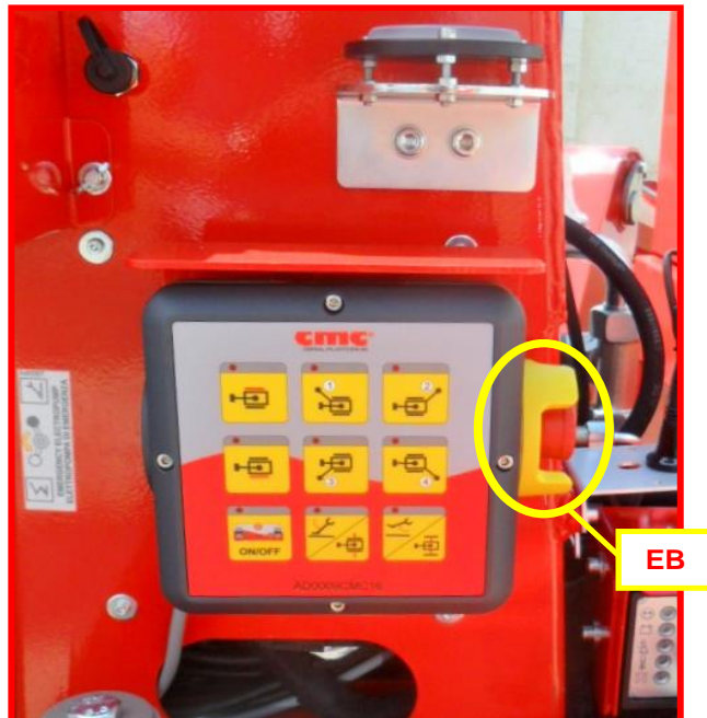
Figure 15 : poste de contrôle stabilisateurs.
