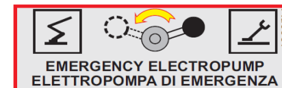
Afbeelding 91: kraan uitwisseling gebruik elektrische pomp*.
