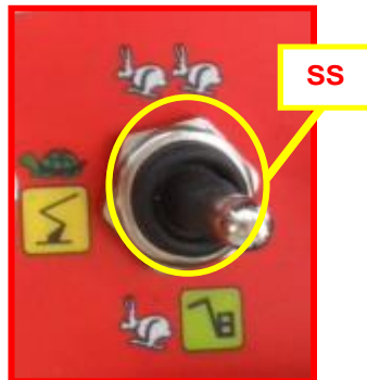
Afbeelding 22: keuzeschakelaar snelheid op afstandsbediening.
