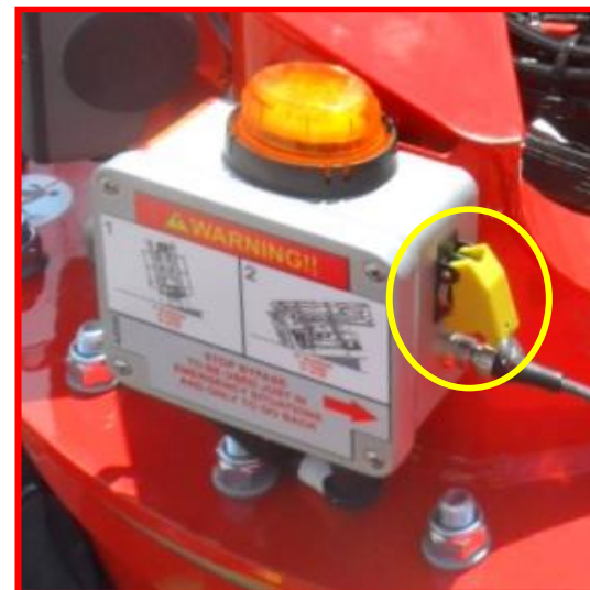
Afbeelding 24: toets voor bypass verplaatsingsblokkering.
