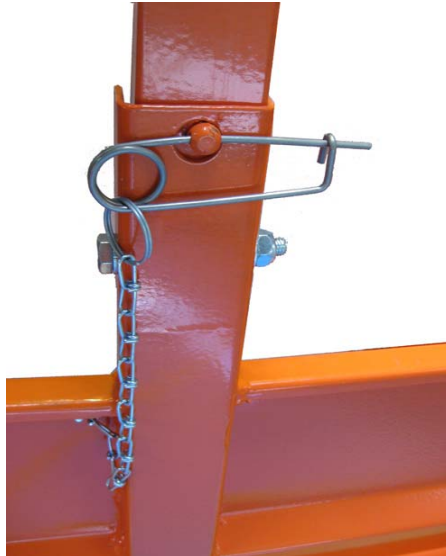
Gesloten hekwerkborging op het platform
