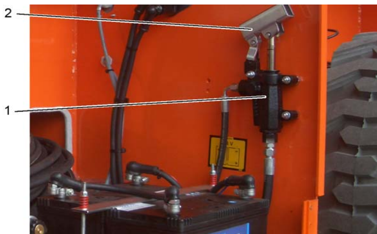
Handpomp voor het uitschuifdeel van het platform
