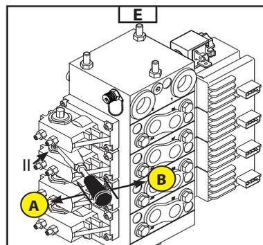
**Pour lever et descendre le bras supérieur** (positionner le levier sur III).
