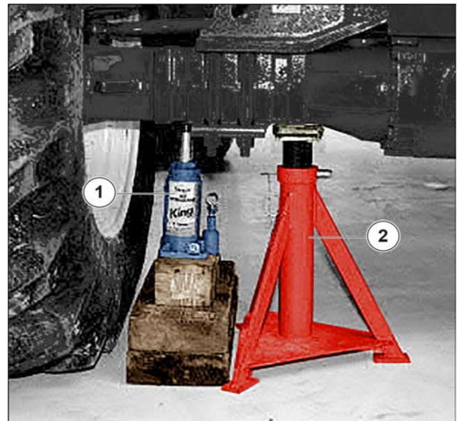
Afbeelding 212: Een wiel vervangen
