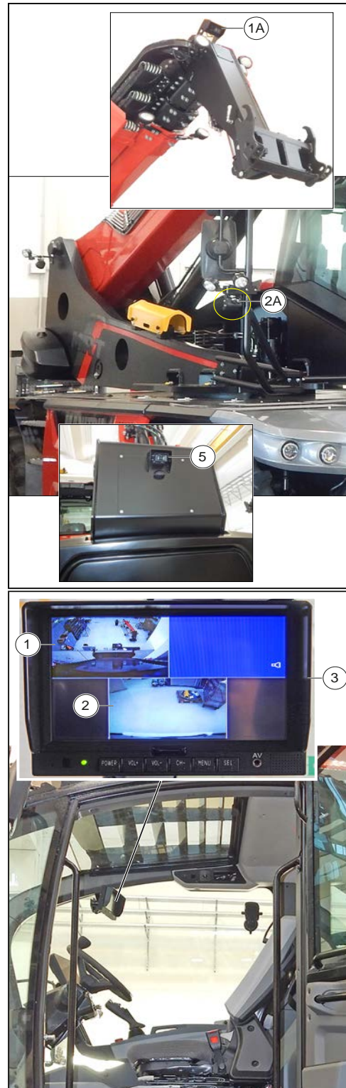
Figure 114: Système de caméra avant et latérale
