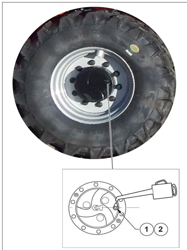
Figure 162: Vérification du niveau d'huile des réducteurs de roues avant et arrière
