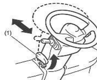
(1) Levier de réglage de l'inclinaison de la colonne de direction
