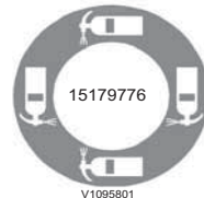
22 Repère des trous pour l'extinction manuelle
