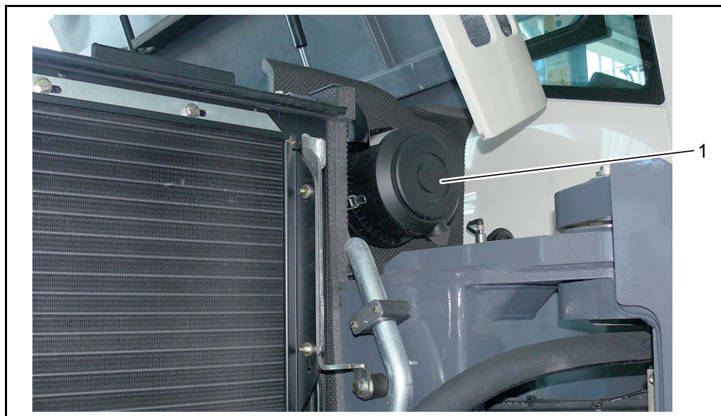
Afb. 6-9 Onderhoud van de luchtfilter
